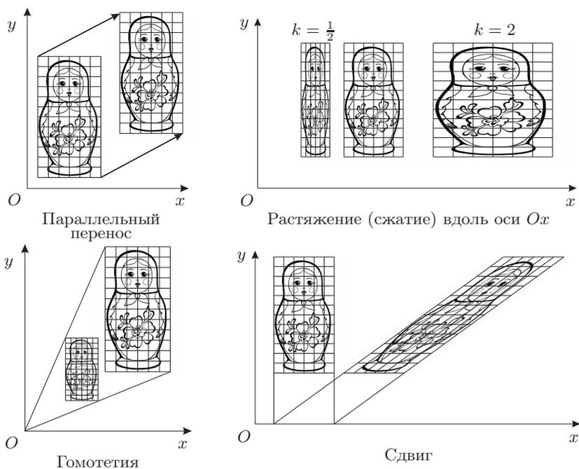
Рис. 12.3. Аффинные преобразования плоскости
