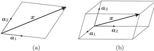
Рис. 2.7. Разложение вектора по базису (а) на плоскости; (б) в пространстве
