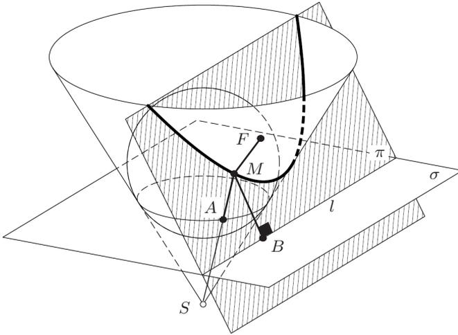
Рис. 11.22. Конструкция Данделена: парабола
