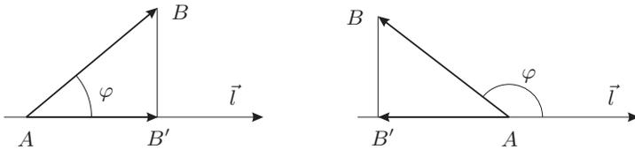
Рис. 1.12. Ортогональная проекция направленного отрезка на ось координат
