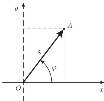
Рис. 1.21. Полярные координаты на плоскости
