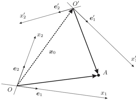
Рис. 12.1. Преобразование аффинного репера
