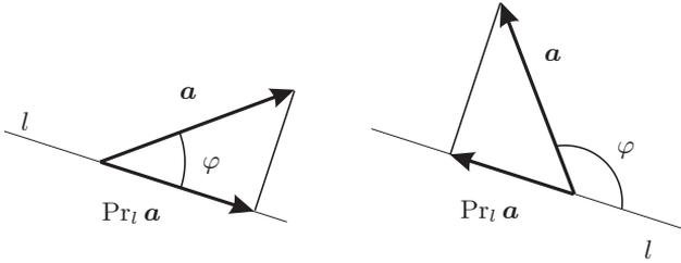
Рис. 2.9. Ортогональная проекция вектора на прямую
