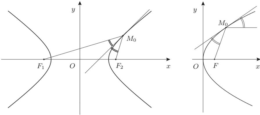
Рис. 11.12. Оптические свойства гиперболы и параболы эллипса
