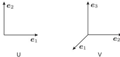
Рис. 2.8. Ортонормированный базис (а) на плоскости; (б) в пространстве
