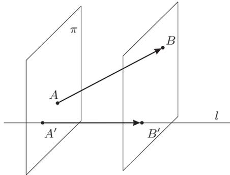
Рис. 1.13. Проекция направленного отрезка на прямую  $l$  параллельно плоскости  $\pi$
