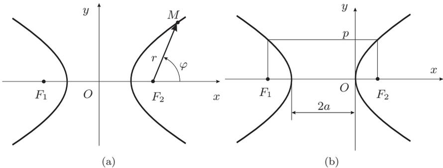
Рис. 11.15. Гипербола (а) в полярной системе координат, (б) в декартовой системе координат, отнесённой к правой вершине
