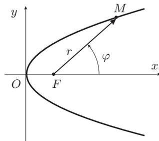
Рис. 11.13. Парабола в полярной системе координат
